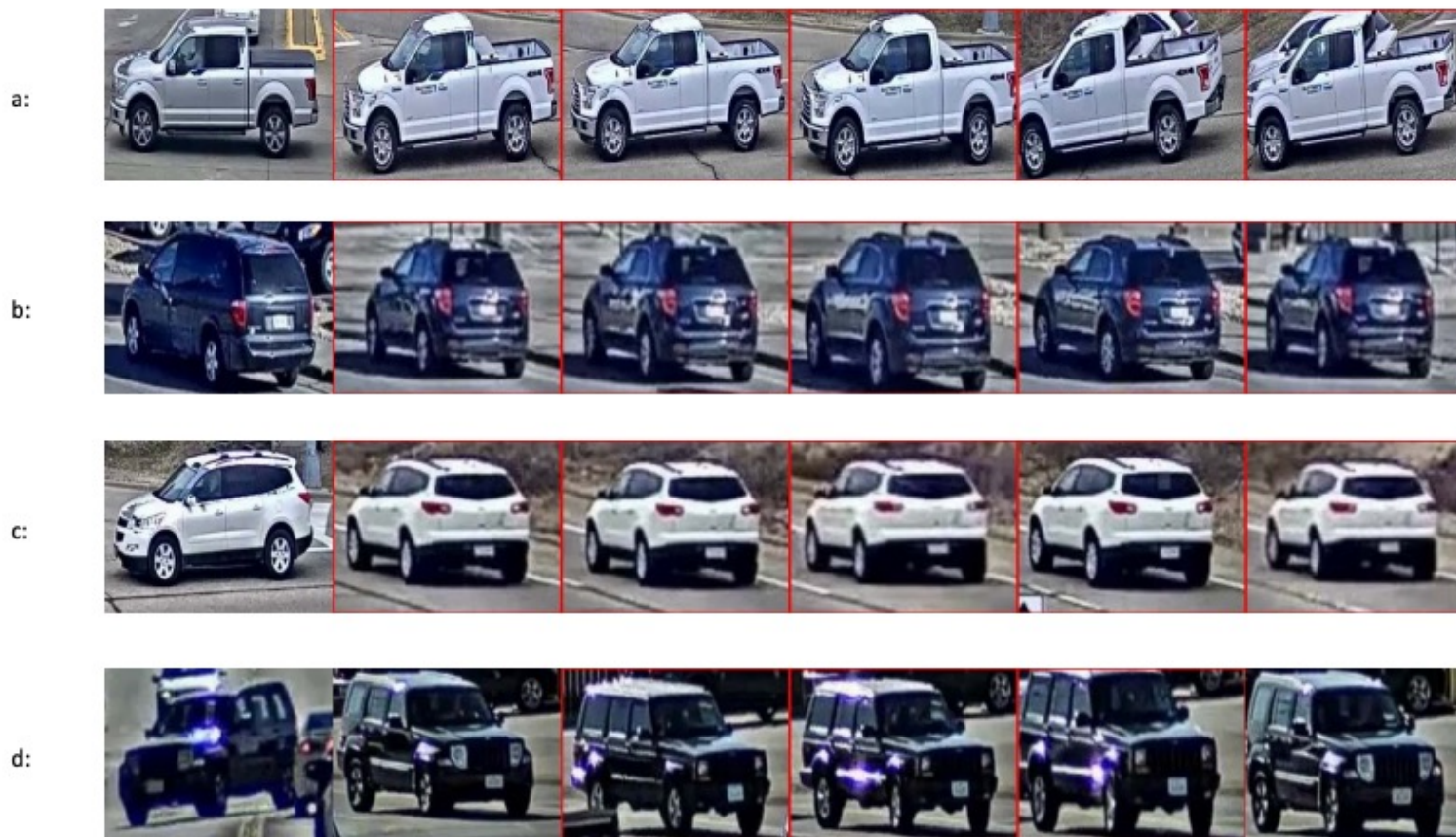
Obrázok1: Ukážka prípadov zlyhania reidentifikácie (a, b rovnaký smer) a (c, d podobné pozadie)
