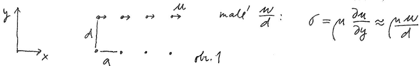
unová' hodnota nula pre  $u = 0, \pm \frac{a}{2}, \mp a, \dots \rightarrow$  jednoduchý model  $\sigma = \sigma(u)$ :
