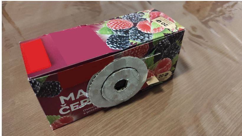
Obr. 4.1: Prototyp upevnenia polarizačných filtrov na kameru
