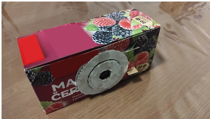
Obr. 4.1: Prototyp upevnenia polarizačných filtrov na kameru
