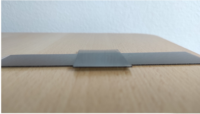
Obr. 3.1: Ilustračný obrázok polarizačných filtrov umiestnených na sebe
