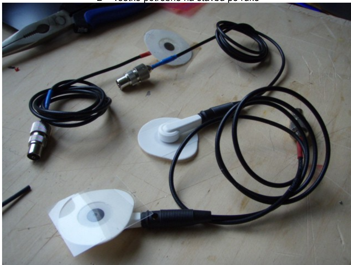
C – Zvodové elektródy
