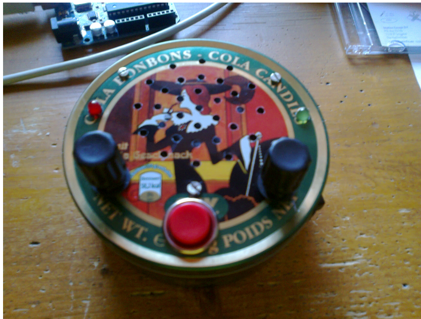
Obr. 2: Hotový LunaMod, ľavý potenciometer ovláda tempo, pravý potenciometer ovláda frekvenciu, červená led vľavo indikuje tempo, zelená led vpravo zapnutie/vypnutie.
