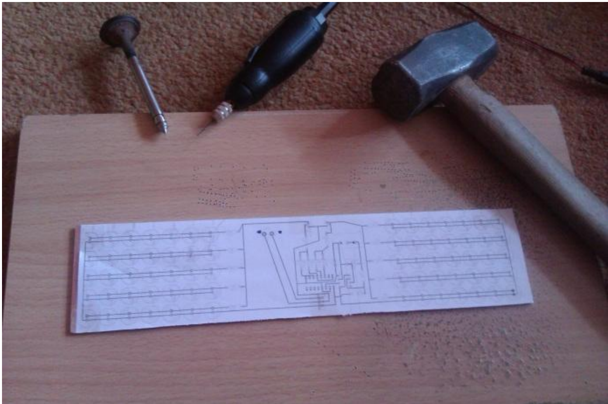
Obr. 3 – Príprava na vrtanie dier;
