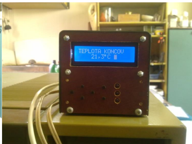
Menu ukazující úvodní obrazovku (čas dátum a teplotu v peci) a teplotu konců termočlánků typu K.
