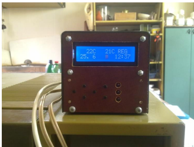
Menu ukazující úvodní obrazovku (čas dátum a teplotu v peci) a teplotu konců termočlánků typu K.
