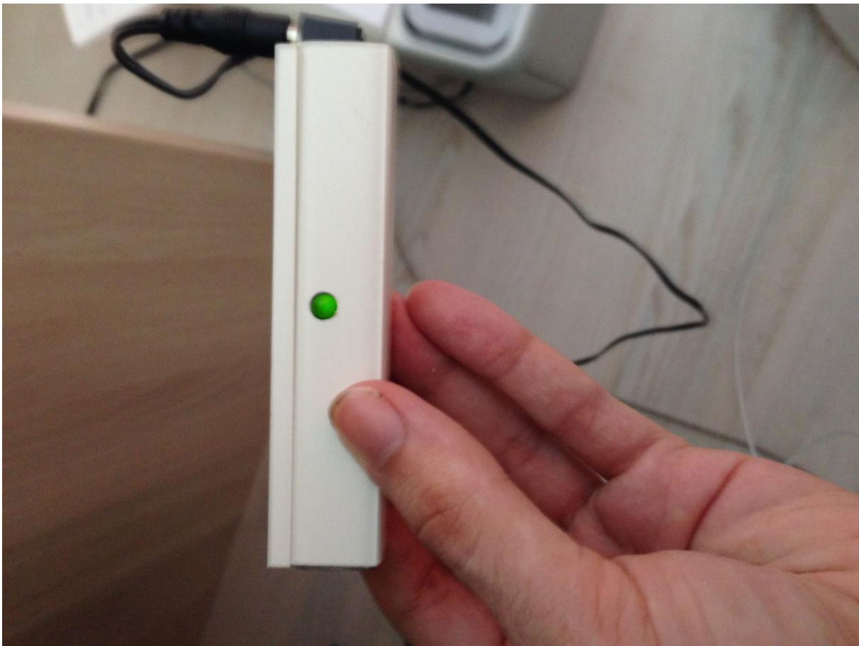
Obr. 3 – zapojený prístroj v krabičke, svietajúca dióda signalizuje vyslanie impulzu
