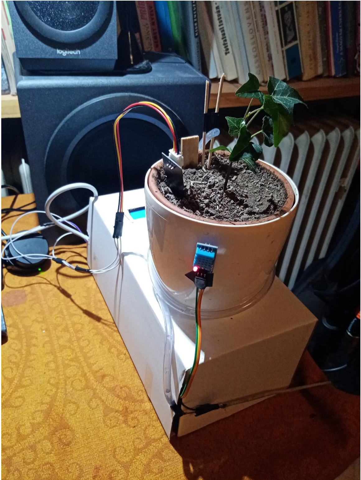
Obr.2. Systém vložený do krabice. Na kvetináči je senzor teploty a vlhkosti, do zeme je zastrčený senzor vlhkosti pôdy a držiak na hadičku. Z krabice cez otvor idú: senzori, usb-kábel na pripojenie počítača, usb-kábel pre zdroj pumpy, hadica.
