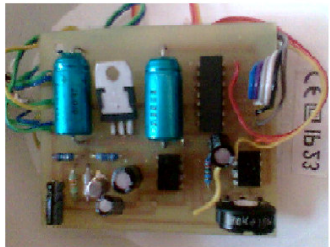
Obr.4. Doska s plošnými spojmi (bistabilný a monostabilný klopný obvod, čítač)
